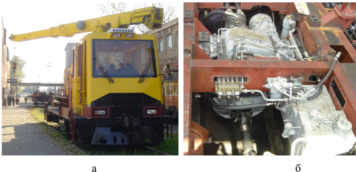
Рисунок 3.22 – Мотовоз технологічний МТ-1: а – загальний вигляд мотовоза; б – ГОМТ, встановлена на мотовоз
